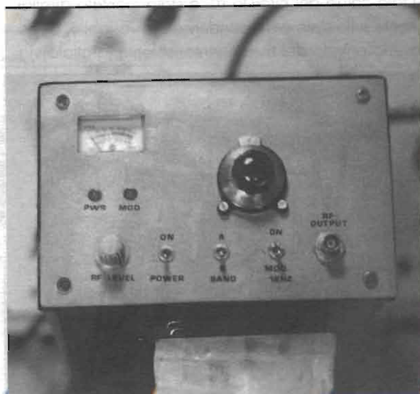
Foto 4 - Il frontale del generatore RF: da sinistra in basso il controllo del livello d'uscita e gli interruttori a levetta per l'alimentazione, la selezione dell'oscillatore (A o B) e la modulazione. In alto, al centro, la manopola demoltiplicata 1:3 per la sintonia degli oscillatori. I due LED indicano la presenza di alimentazione e l'inserimento della modulazione.
